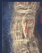
Presek zaprljanog filterskog materijala
